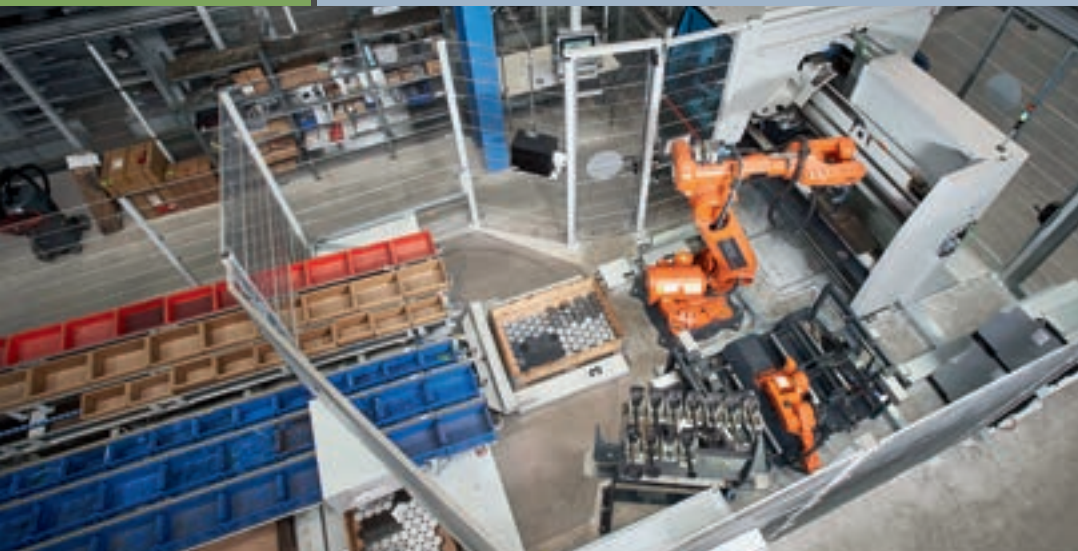
Alle Schritte automatisiert: das neue Hochleistungs-Sägezentrum von Hagelauer Dewald in Pleidelsheim
